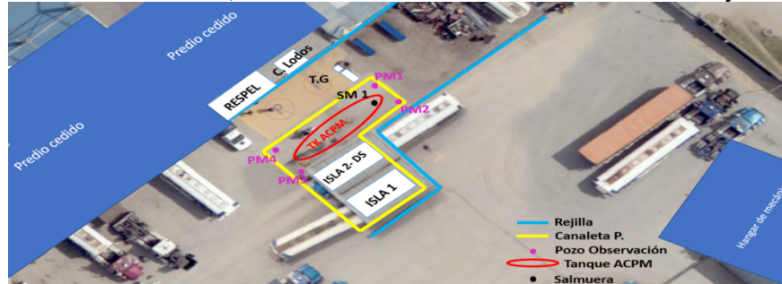
Figura 2. Estación de servicio, localización de unidades de almacenamiento y distribución.
